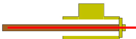
Placering af føler i følerrør
