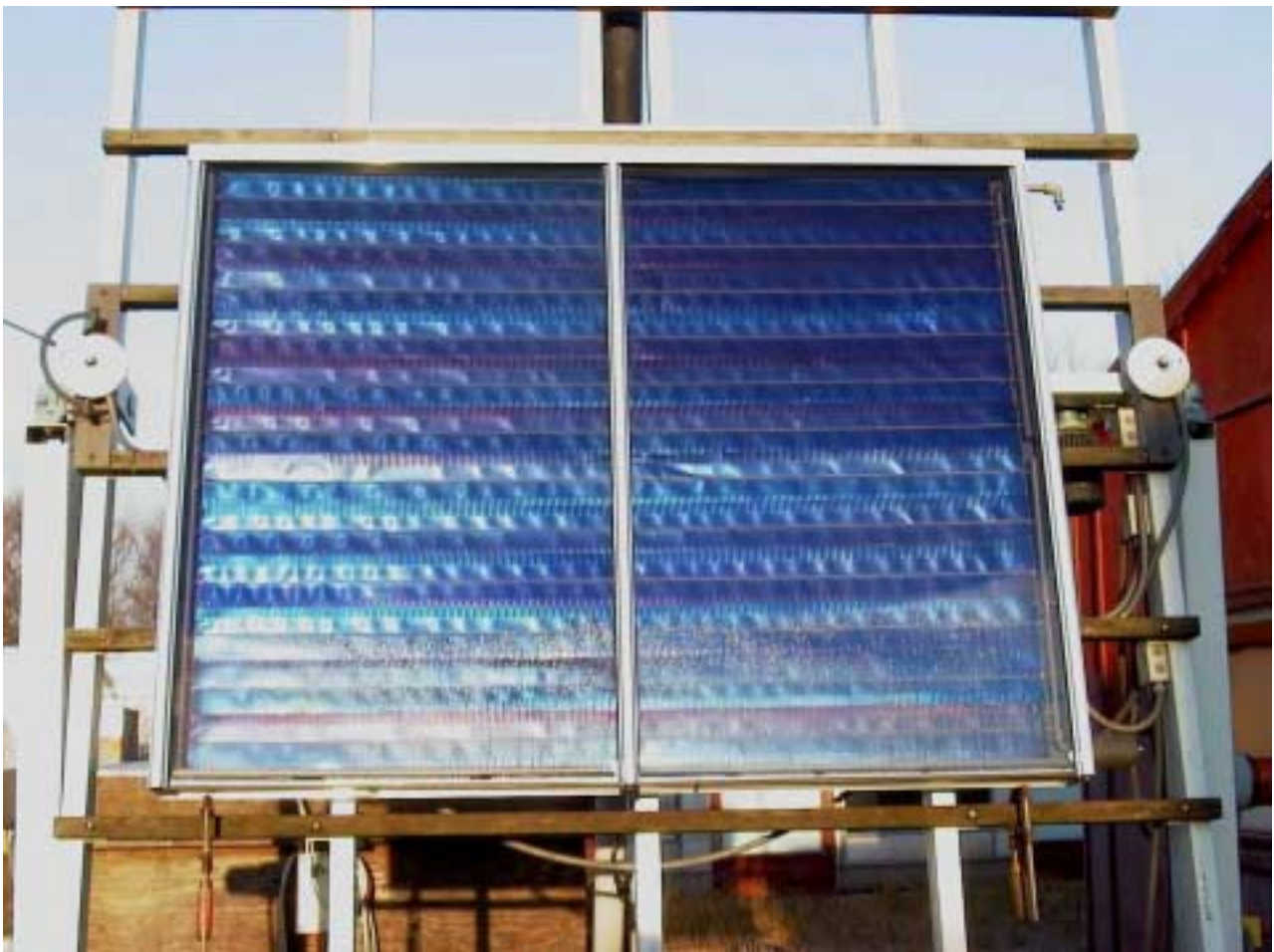
Figur 3.1 Solfanger i soltrackeren.
